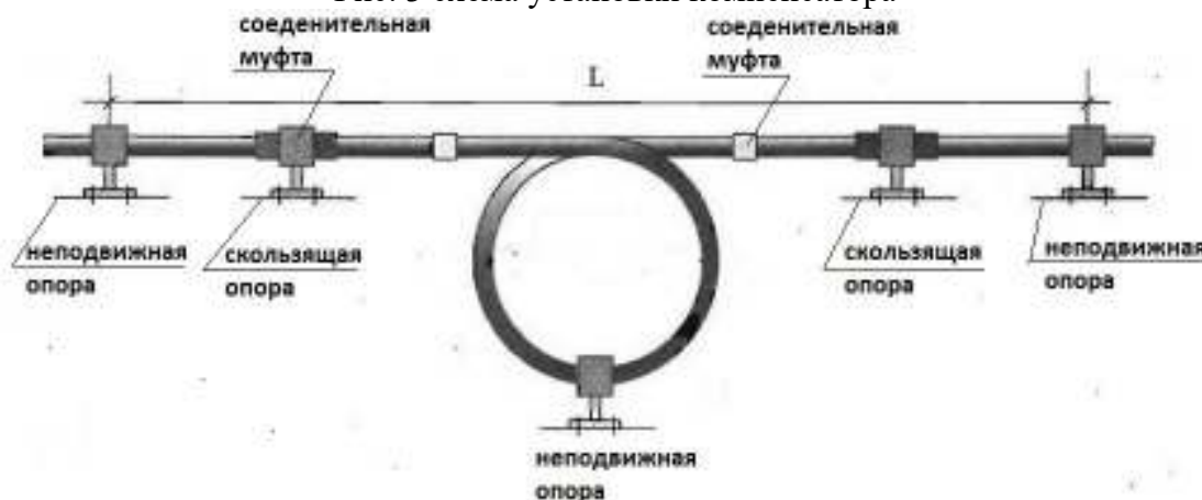
Рис. 3 схема установки компенсатора
